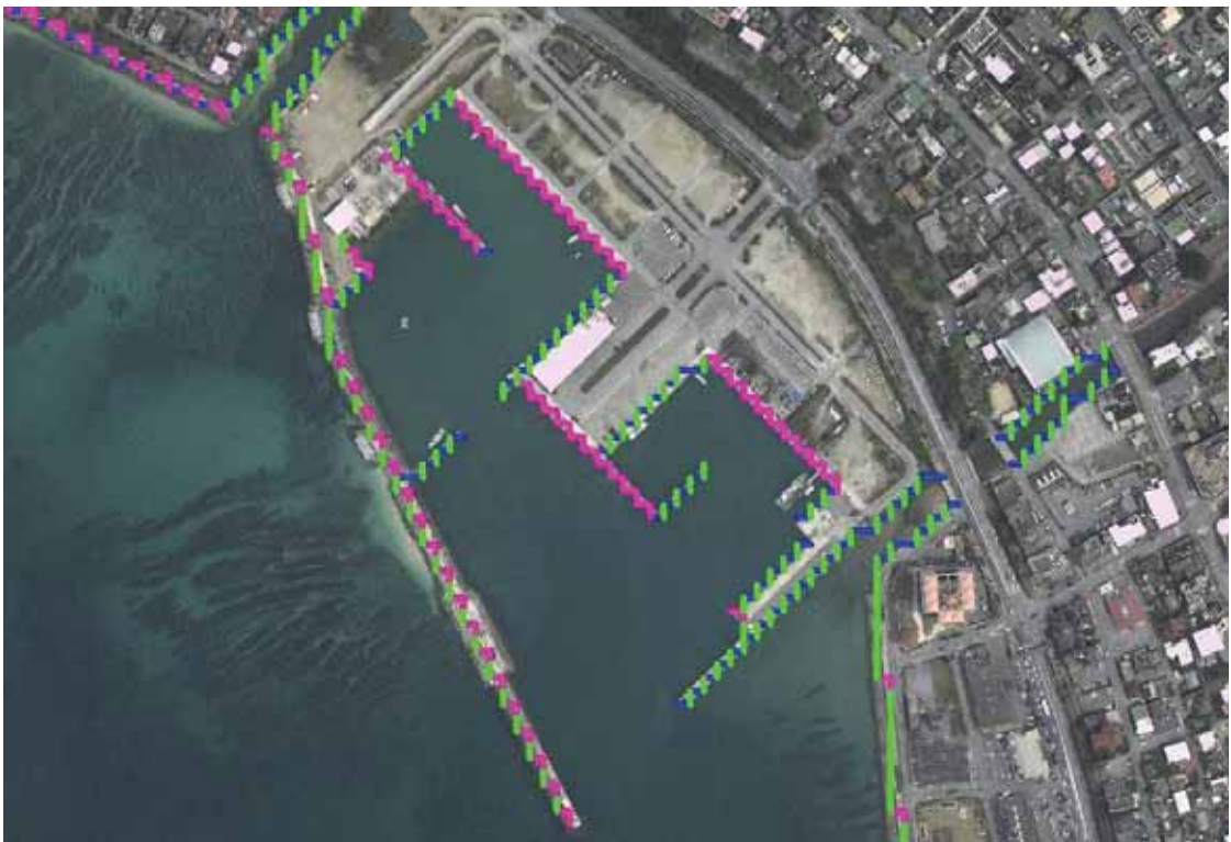
図 3.4.2 構造物データ(メッシュ辺上にモデル化したブレイクラインデータ)の例
