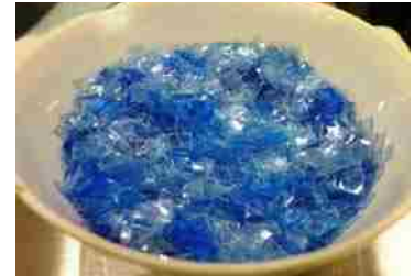
写真 4.4 単体サンプル(容器 1 個)からなる細片状の分析サンプル(原子吸光分光分析用)
