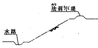
(法面工における施工概念図)
