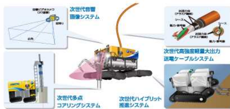
ROV による高効率海中システムの開発（海底鉱物資源等の試料採取目的） （出典）JAMSTEC
