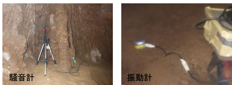
図 5.7 測定機器設置状況
