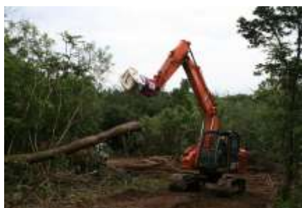
H23 単木択伐実証試験 (ウィンチ付グラップルによる収穫)
