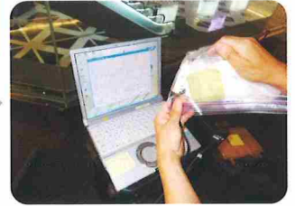
④密閉バッグ内のTVOCを4分間測定し、ピーク値を記録
