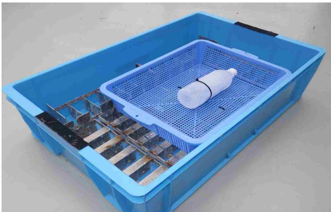
図 2.2.2-38 ペットボトル氷とコレクターホルダーの移送用ケース
