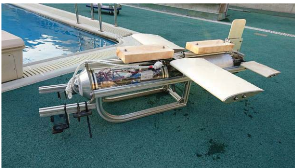
図3-6-2. 製作した曳航型水中ロボット。
