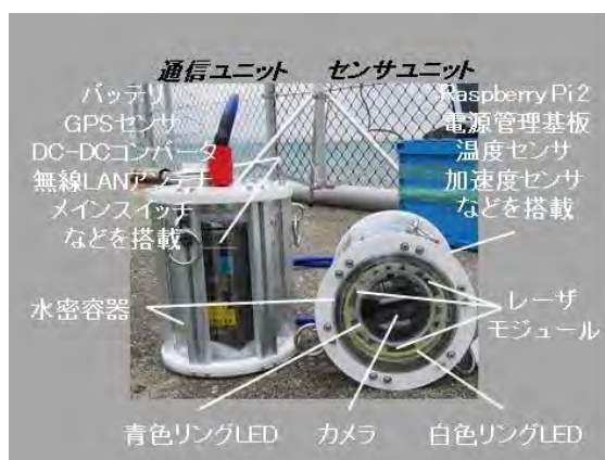
図3-8-32. 定点SNの外観。
