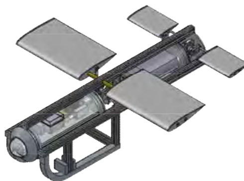
図3-8-2. 曳航型水中ロボット。
