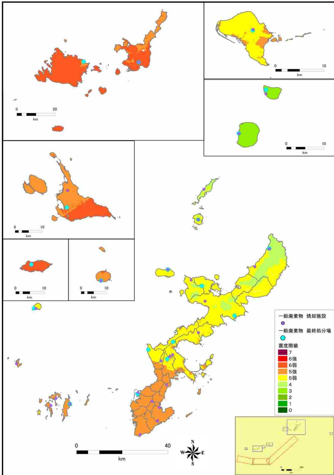
一般廃棄物処理施設と八重山諸島南方沖地震3連動（L2）の震度分布図
