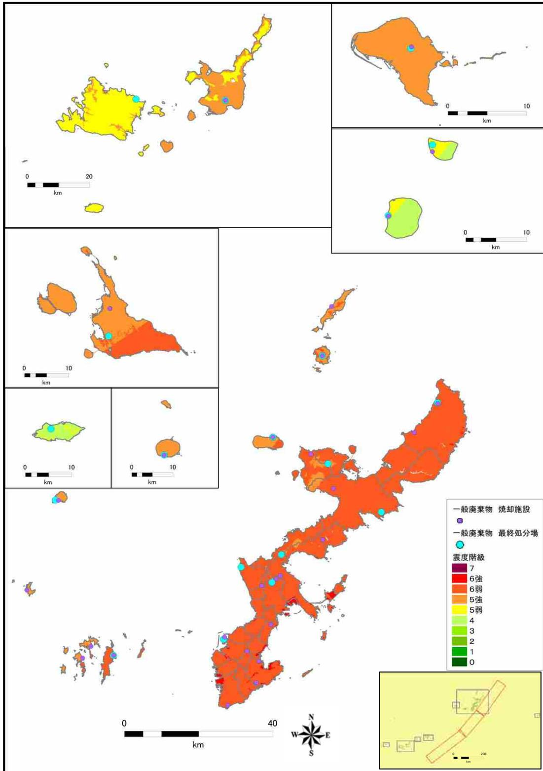
一般廃棄物処理施設と沖縄本島南東沖地震3連動（L2）の震度分布図
