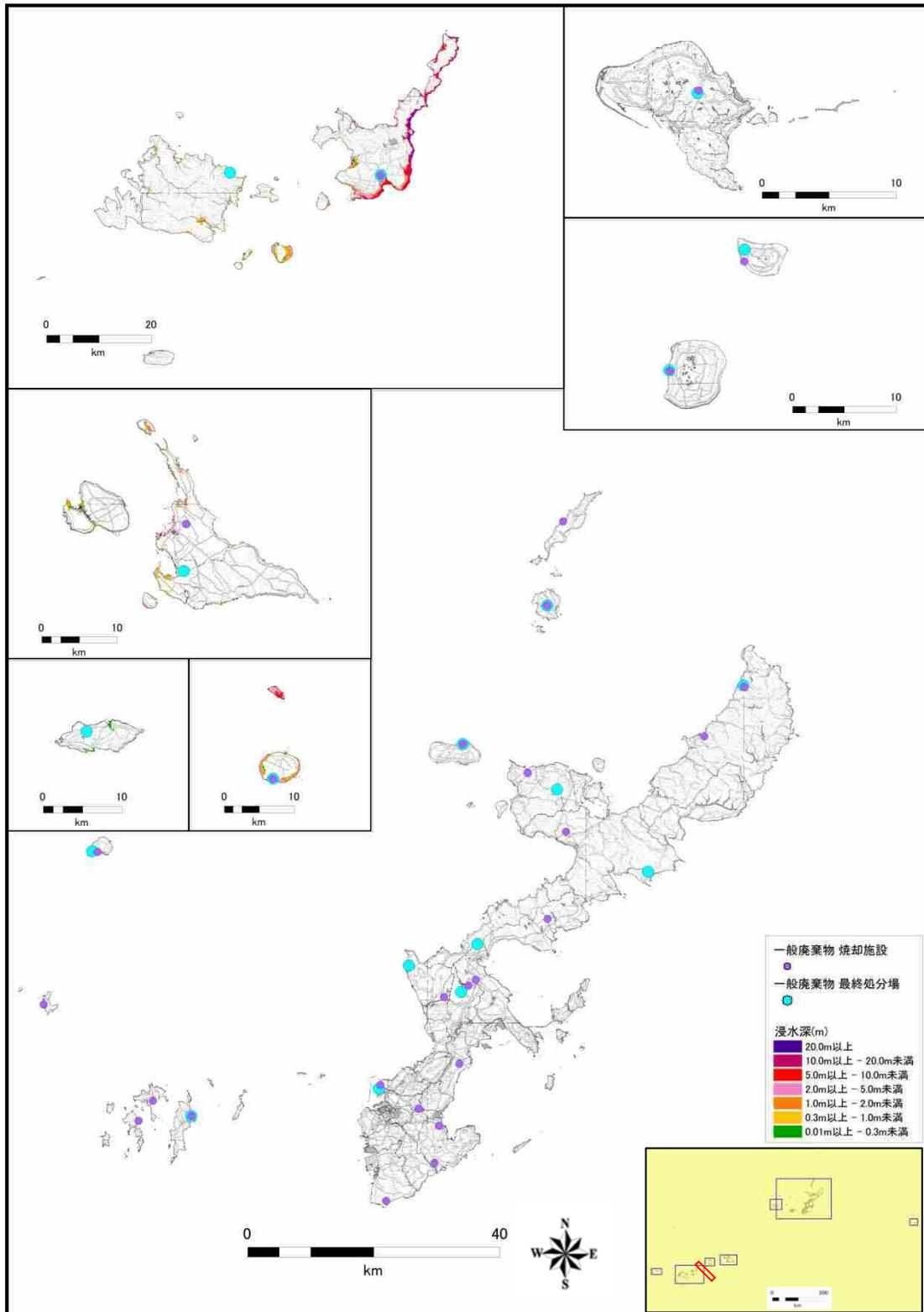
一般廃棄物処理施設と石垣島東方沖地震（L1）の津波浸水予測図
