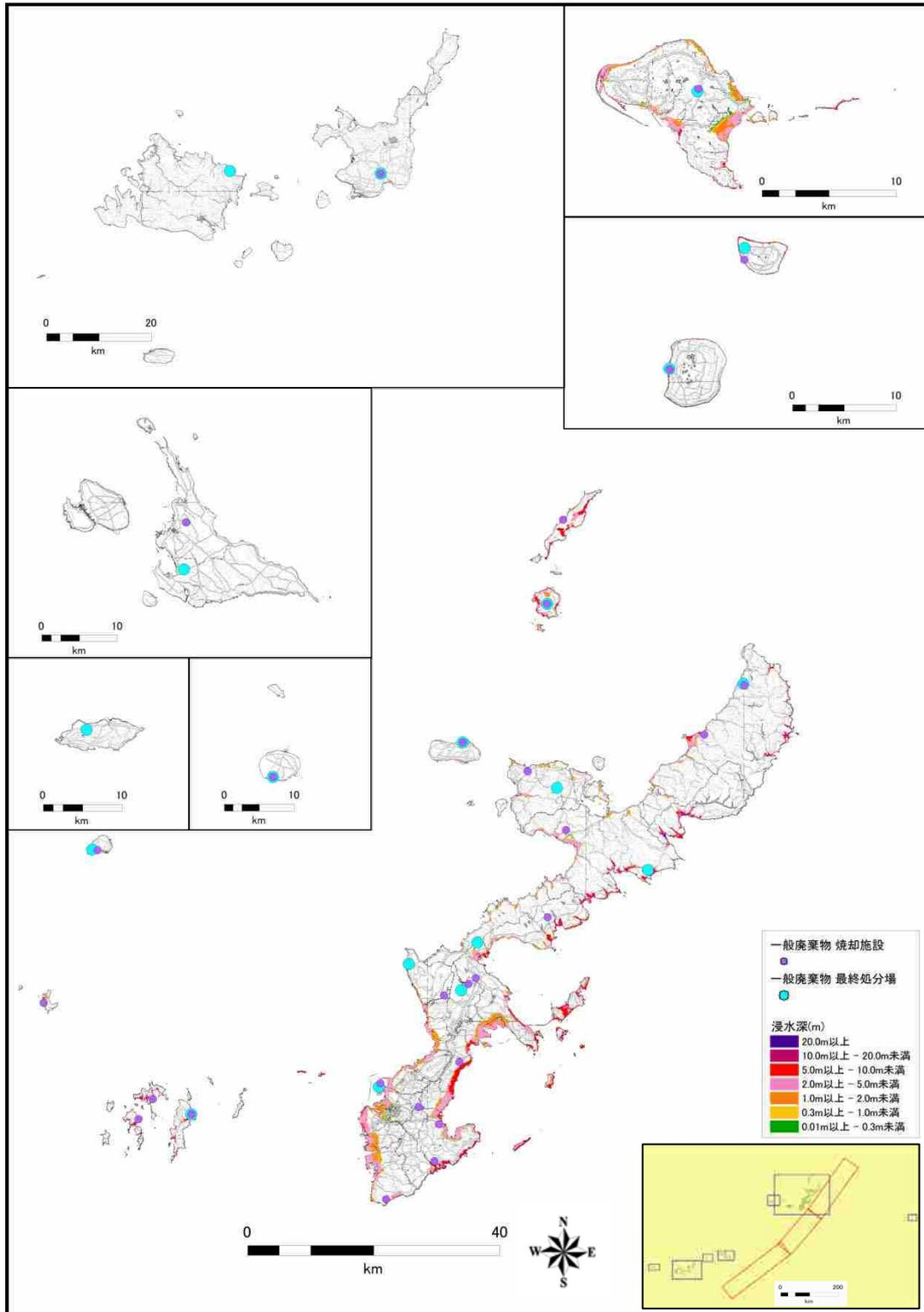
一般廃棄物処理施設と沖縄本島南東沖地震3連動(L2)の津波浸水予測図
