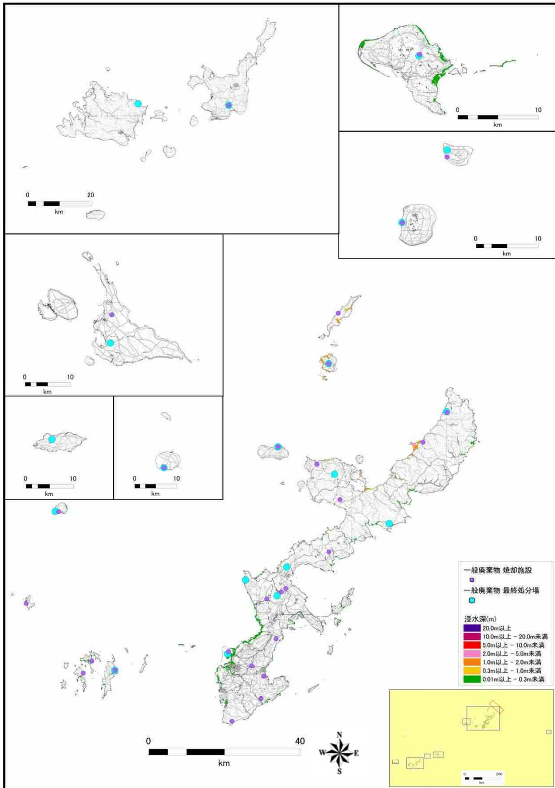
一般廃棄物処理施設と沖縄本島北方沖地震（L1）の津波浸水予測図
