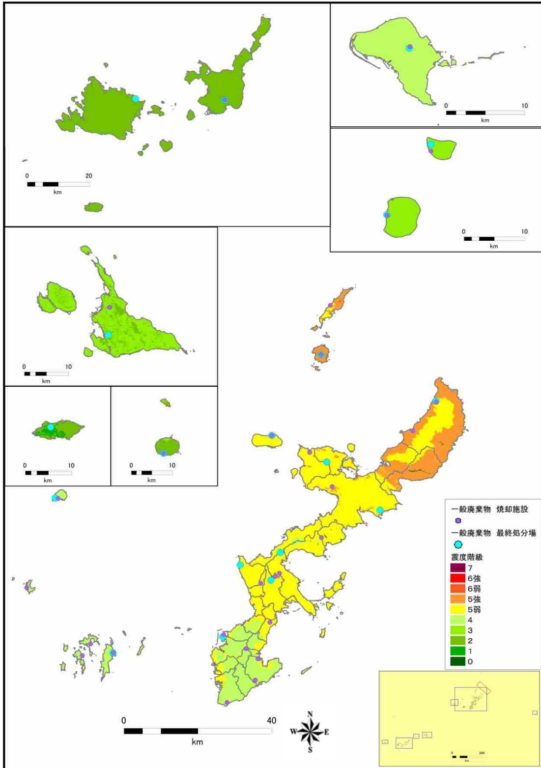
一般廃棄物処理施設と沖縄本島北方沖地震（L1）の震度分布図
