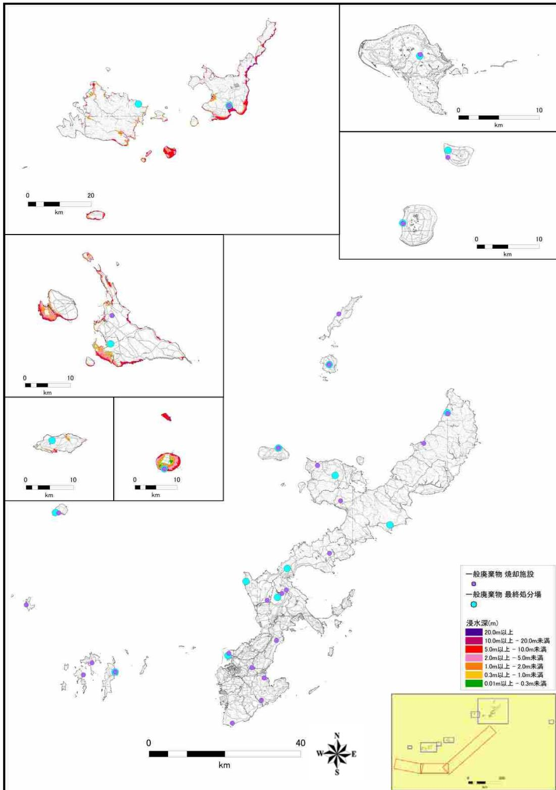
一般廃棄物処理施設と八重山諸島南方沖地震3連動（L2）の津波浸水予測図
